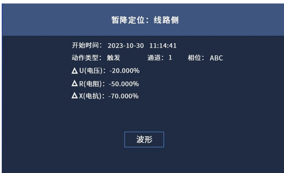
图 4.25(a) 电压暂降源定位-线路侧
