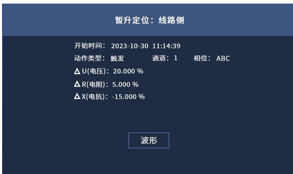
图 4.25(b) 电压暂升源定位-线路侧
